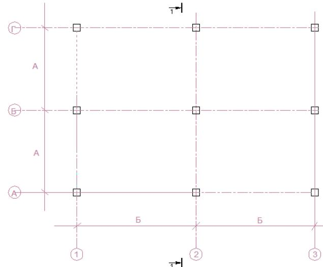
Фундаментную плиту принять толщиной 500 мм, бетон конструкций – класса В25. Нагрузки и данные, не описанные в таблице задания принять по Примеру 4.
